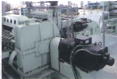
鋼板飛剪設備
